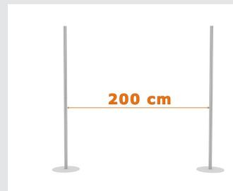
**Fase 5** - Ripetere le FASI 1,2,3 e 4 per ottenere una seconda piantana da posizionare ad una distanza di 200 cm.
